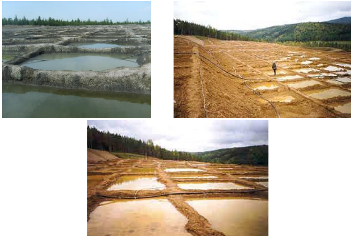
Рис. 1.10. Применение прудкового орошения штабеля КВ
