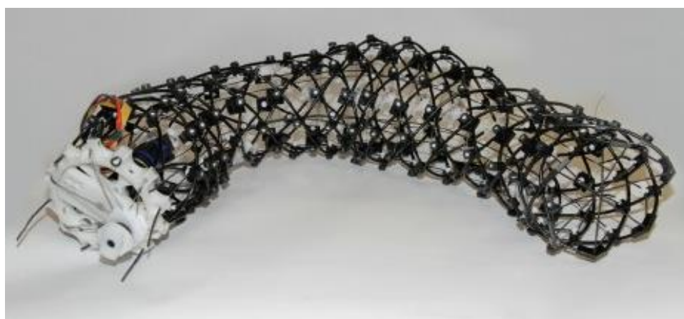
Рис. 3.17. Робот, созданный по принципу перистальтического движения с постоянно деформируемой внешней поверхностью [82]
